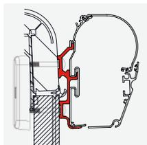
Calha de montagem a todo o comprimento
